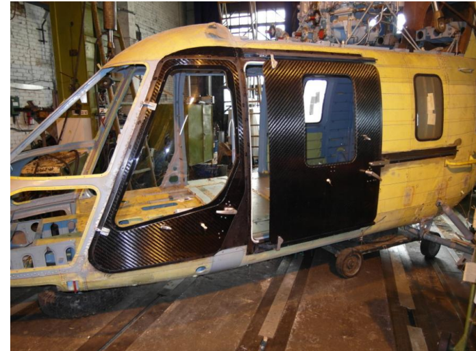
Function (bench) tests of door hood modules
